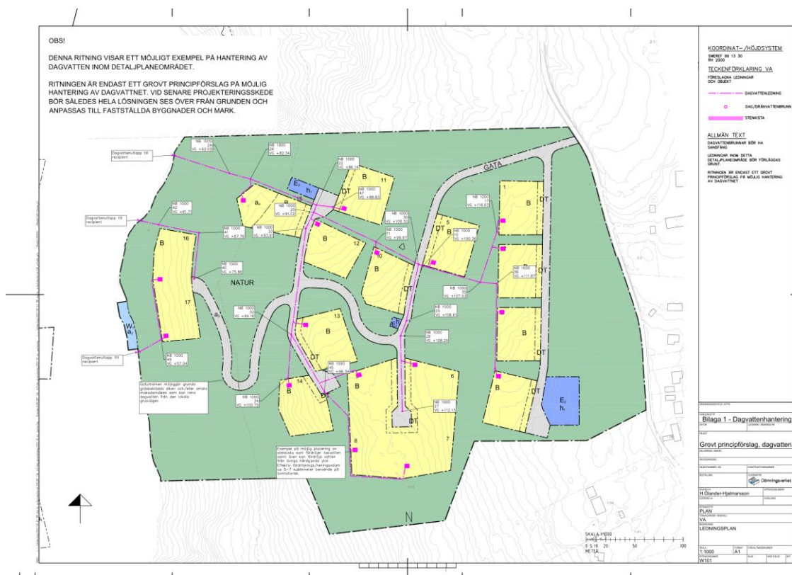
Figur 10. Översiktligt förslag på dagvatten- och skyfallshantering inom detaljplaneområdet. Se Bilaga 1 för större bild.
