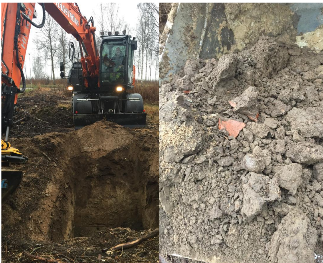
Figur 4. Foton från fältarbetet. Provgropsgrävning och 16ÅF01 0,7-1 m med tegelrester. Foto: ÅF 2016
