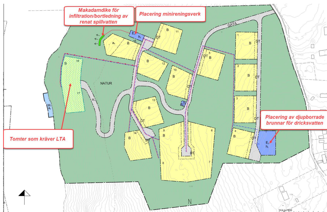
Figur 4. Översiktsskild för VA inom planområde. Se Bilaga VA ledningsplan för mer högupplöst ritning.
