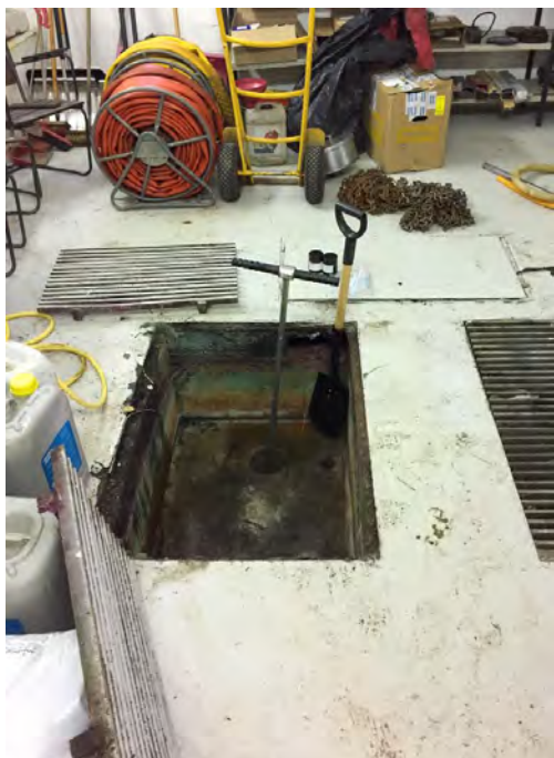
Figur 2. Provtagning med handskruvborr under golvgrav i 17ÅF03.
