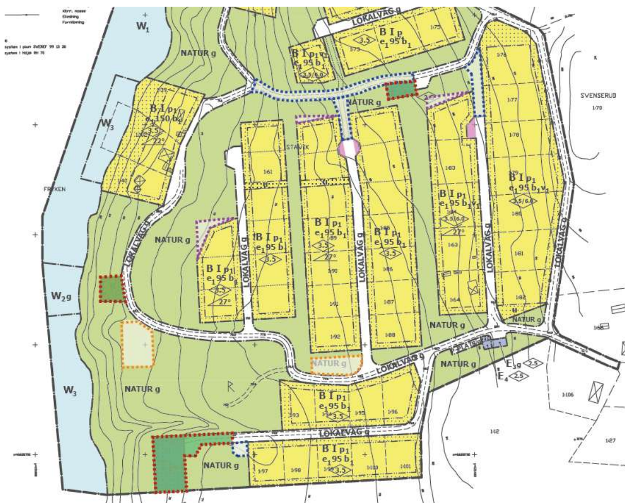
Figur 16. Kartan visar med grönt område med röd streckad linje de områden som i och med ändringen kommer att bli naturmark. Ytorna omfattar gatumark, gemensamhetslokal, vattenverk och avloppsanläggning. Blå streckad linje visar de ytor som tidigare varit natur som nu blir gatumark. Lila streckad linje visar de ytor som tidigare var natur som blir bostadsmark. Orange streckad linje visar de ytor som tidigare var natur som blir avloppsanläggning samt vattenverk. Illustrationen är inte inritad från digitalt underlag varför gränserna inte ska ses som exakta.
