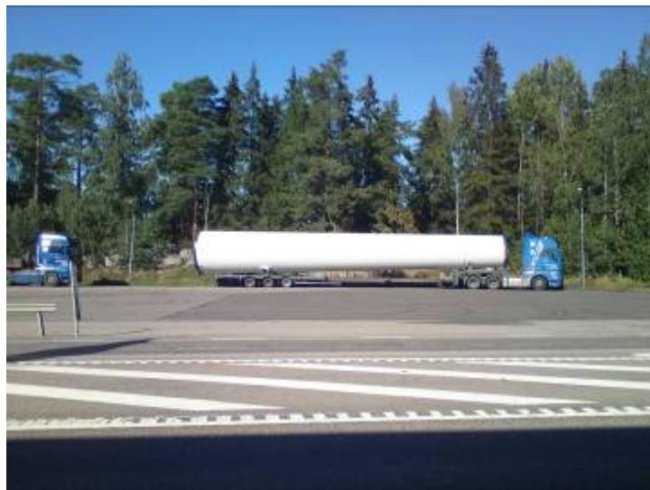
Figur 2. Transport av ett vindkraftstorn sker vanligen med lastbil. Tornet fraktas i delar som monteras på plats med hjälp av en kran.
